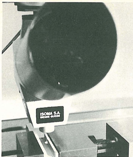
Vermessung der komplizierten Metallgehäuseschalen auf der elektronischen Messmaschine Olivetti Inspector.
