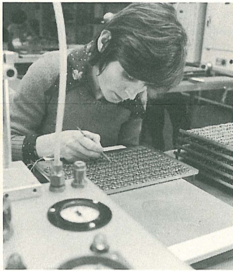
Imprägnieren der Kernwicklungen mittels speziellem Dosiergerät.
